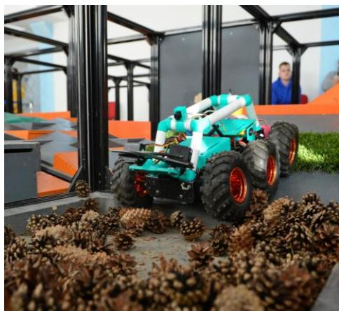
Испытание на проходимость, для его создания используются реальные шишки, которые засыпаются в короб на глубину 40 мм. Поскольку короб имеет дополнительные отступы от краев ячейки, обязательным условием для прохождения испытания является проезд через середину квадрата.
