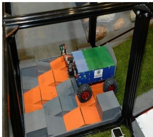
Ячейка заполнена 25-ю закрытыми коробами (рампами). Верхняя грань каждого короба имеет наклон в 15°. Рампы составлены таким образом, что их верхние поверхности образуют по высоте волнообразную структуру.
