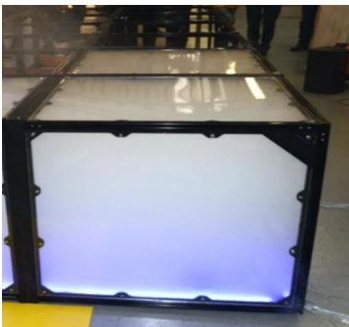
2-3 куба с сильным задымлением, создаваемым дыммашиной. Стенки куба выполнены из прозрачного оргстекла. К полу кубов в произвольном порядке прикручены шипы и светильники из оргстекла, которые можно включить роботом при помощи кнопки, расположенной на полигоне. Секции имеют въезды - арочные проемы 500x500, занавешенные полосками резины.
