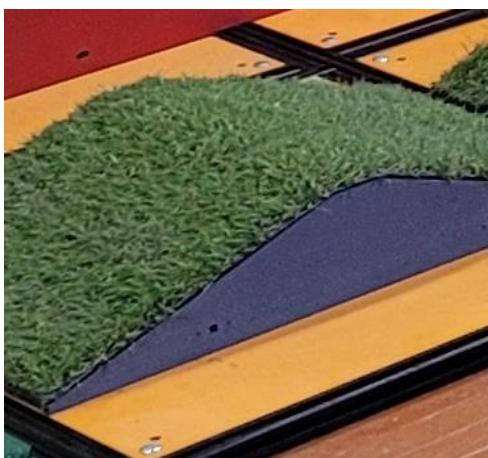
Испытание представляет собой двускатную наклонную 15°, с габаритными размерами 420x690x160, на которой закреплена полоса искусственной травы или камни. Высота ворса 15 мм, габариты камней – произвольные, но высота камня не более 40 мм. Ширина боковых проемов по краям горки – 163 мм (считая профиль).
