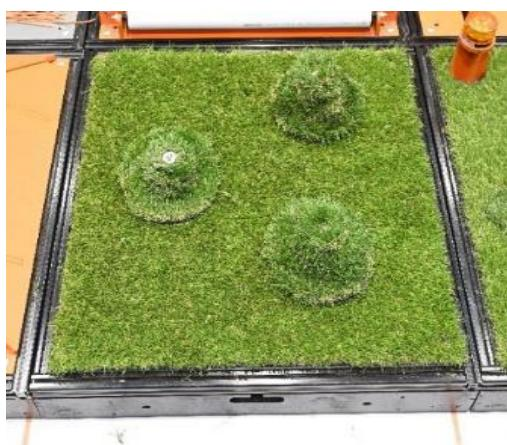
Площадка, покрытая искусственной травой из полипропилена с высотой ворса 18 мм. На ней произвольным образом расположены наборные конструкции из искусственной травы, имитирующие деревья. Максимальный диаметр «дерева» 150 мм, максимальная высота «дерева» 110 мм.
