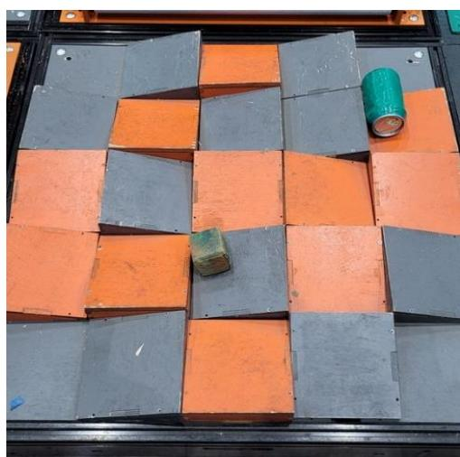
Ячейка заполнена 25-ю закрытыми коробами (рампами). Верхняя грань каждого короба имеет наклон в 15°. Рампы составлены таким образом, что их верхние поверхности образуют по высоте неравномерную структуру. Рампы разной высоты с перепадом высот 50 мм.
