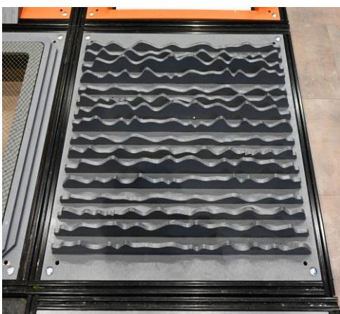
Плоская площадка с прикрепленными к ней перпендикулярно фанерными планками с волнообразной кромкой. Планки расположены параллельно друг другу. Высота может колебаться от 10 до 80 мм.
