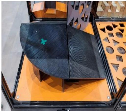
Куб, внутри которого расположено препятствие представляющая собой резкий подъем, поворот и спуск. Высота подъема – 200 мм. Препятствие покрыто резиной для лучшего сцепления робота с поверхностью при подъеме и спуске.
