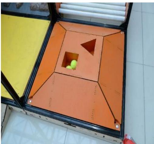
Препятствие включает в себя основание, выполнено в виде усечённой пирамиды с призматическими выемками в верхней части, внутри которых расположены обломки. Глубина выемок – 110 мм. Угол наклона скатов испытания - 30°. За захват и доставку каждого обломка баллы начисляются отдельно.
