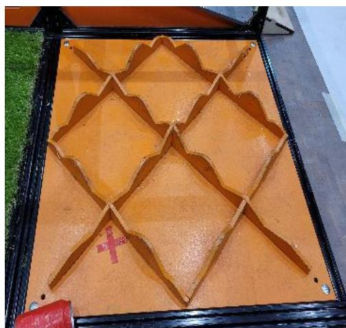
Плоская площадка с прикрепленными перпендикулярно к ней фанерными планками с волнообразной кромкой. Высота планок может колебаться от 10 до 80 мм.
