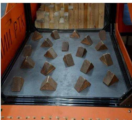
Плоская площадка, на которой закреплены деревянные призмы. Высота шипа – 40 мм, длина грани – 50 мм, ширина шипа – 40 мм.
