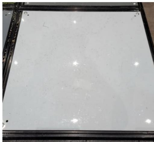
Скользкая поверхность (фторопластовая пластина). Для большей скользкости на поверхность может наноситься универсальная смазка WD-40.
