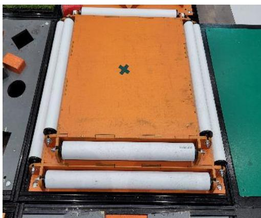
Ступенчатая пирамида, состоящая из двух уровней. Параллельно длинным ребрам каждого уровня закреплены врачающиеся трубы. Общая высота – до 140 мм. Высота ступени - 60 мм.
