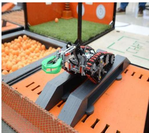
В площадке ячейки проделаны ряды отверстий, в которые вставляются штифты коробов, имитирующих рельсы. Ширина постановки рельс перед стартом регулируется под ширину базы робота, стартующего с ближайшего старта. Баллы начисляются только если робот смог полностью проехать по рельсам.
