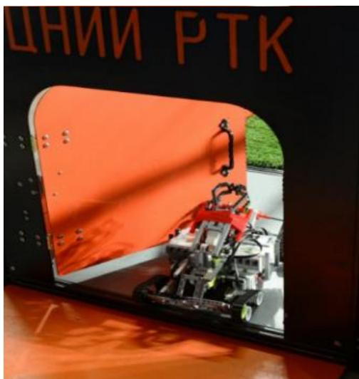
Дверь, открывающаяся на 90° на себя и от себя с ручкой типа «штанга». Габаритные размеры двери - 480x480 мм. Для открытия двери необходимо усилие 200 г (2 Ньютона), т.к. она в нулевом положении удерживается магнитами. Высота ручки двери над полом – 220 мм, толщина – 8 мм, длина – 110 мм. Испытание размещается в одном кубе, в котором может находиться дополнительное испытание.
