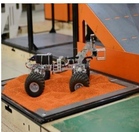
Короб глубиной 40 мм, наполненный песком. Высота слоя песка колеблется в пределах 20-30 мм.
