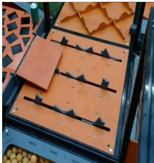
Плоское основание с параллельными прорезями. Внутри прорезей вращаются трёхлучевые звёзды, закрепленные на стержнях, расположенных на тыльной стороне основания. Звёзды выдаются над поверхностью максимум на 70 мм.
