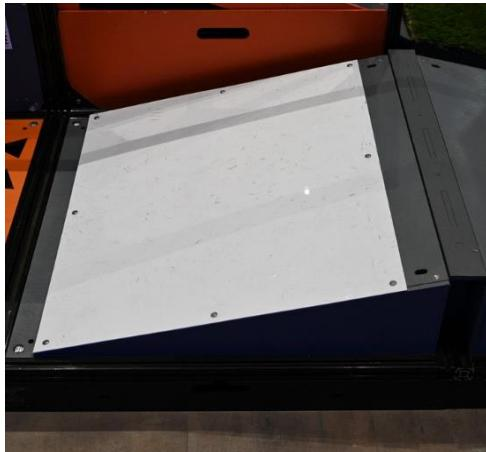
Плоская площадка, установленная под углом 15 градусов, на которой закреплена пластина из полистирола, имитирующая лед.
