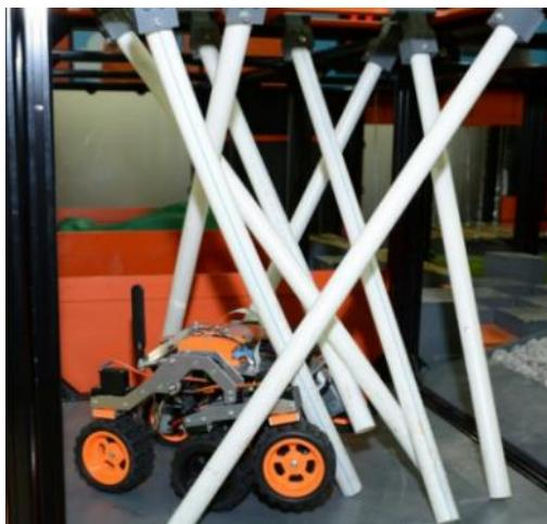
Куб, верхняя грань которого представляет собой площадку с закрепленными на ней разнонаправленными полипропиленовыми трубами. Трубы опираются на нижнюю грань (площадку) куба. Таким образом трубы преграждают путь через куб.
