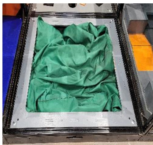
В ячейку уложен полиэстеровый мешок, наполненный до половины полистироловыми шариками фракцией 4-6 мм.
