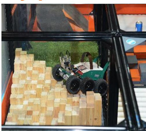
Конструкция из деревянных брусков 50x50мм разной длины, установленных вертикально, плотно друг к другу. Испытание размещается в одном стандартном кубе высотой 800 мм.
