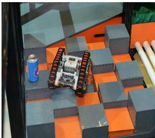
Ячейка заполнена 25-ю закрытыми прямоугольными коробами (рампами) разной высоты с перепадом высот в 50мм.
