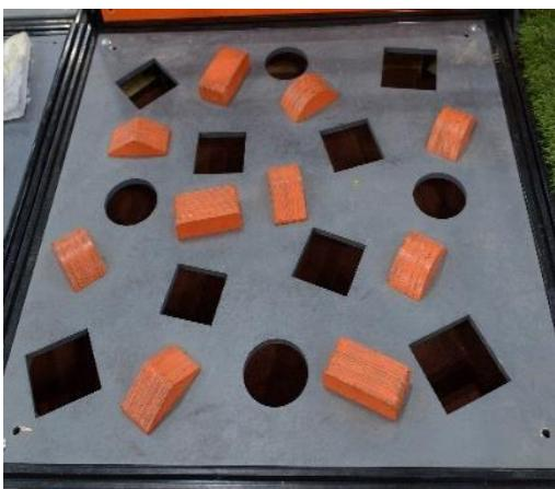
Плоская площадка с отверстиями различной формы. Также, на площадке в произвольном порядке расположены препятствия – шипы из фанеры различной формы. Высота шипа - 50мм. Ширина отверстий до 120 мм.
