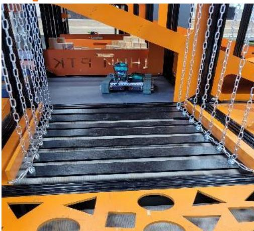
Мост, набран из деревянных планок, подвешенных на цепях к верхним ребрам ячейки (куба). Ширина моста - 500 мм. Ширина одной планки - 65 мм, расстояние между планками - 35 мм. Все планки моста попарно соединены цепочкой, и раздвигаются между собой на ширину не более 65 мм. Высота моста относительно пола ячейки - 80 мм.
