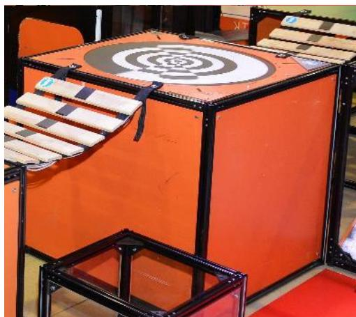
Крутящийся с переменной скоростью диск диаметром 650 мм, установленный в верхней грани ячейки (куба). Материал диска – фанера 10 мм. Поверхность диска покрыта виниловой пленкой.
