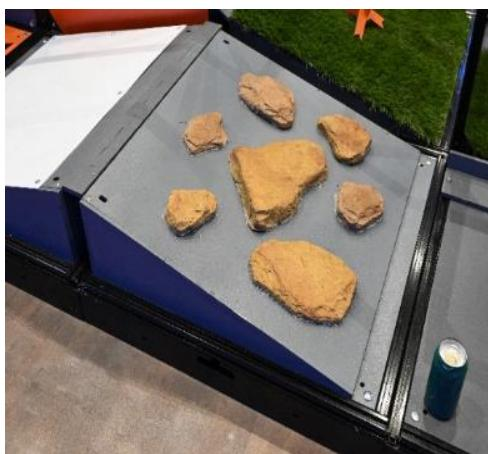
Плоская площадка, установленная под углом 15 градусов, на которой закреплены камни. Высота камней - 15-40 мм.
