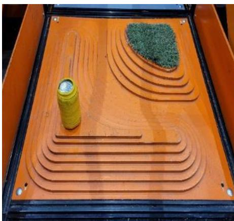
Конструкция состоит из нескольких слоев фанеры, уложенных параллельно друг на друга, которые формируют два возвышения. Высота первого возвышения (выступа) – 70 мм. Высота второго возвышения 50-60 мм.
