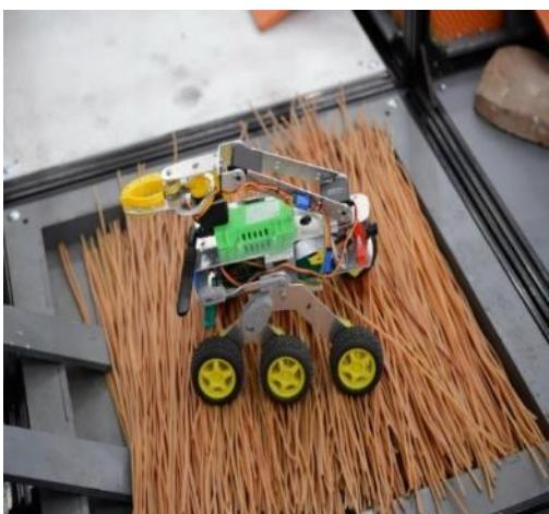
Короб глубиной 40 мм, заполненный проводами. Глубина слоя 20-30 мм.
