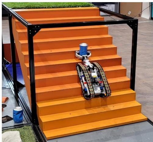
Куб, внутри которого расположена лестница с высотой ступеней 75 мм и длиной 90 мм. Лестница включает в себя прикрученный заезд, вместе с которым состоит из одиннадцати равных прямоугольных ступеней.
