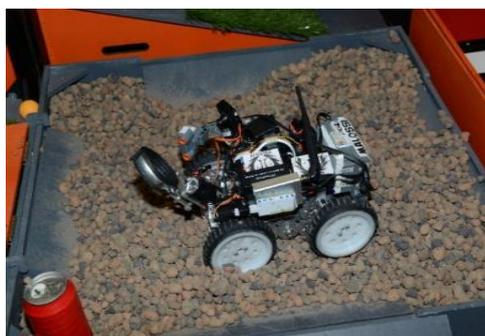
Короб глубиной 40 мм, наполненный керамзитом. Высота керамзитного слоя колеблется в пределах 20-30 мм.
