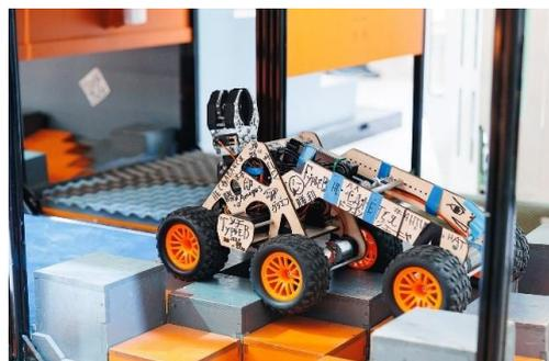
Ячейка заполнена 25-ю закрытыми прямоугольными коробами (рампами) разной высоты с перепадом высот в 50 мм.
