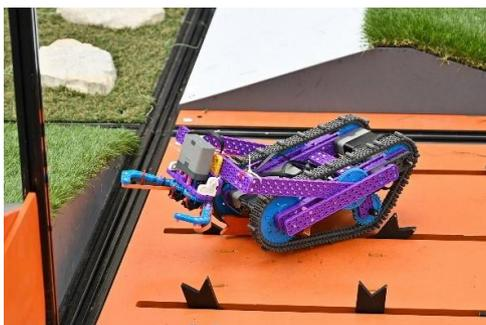
Плоское основание с параллельными прорезями. Внутри прорезей вращаются трёхлучевые звёзды, закрепленные на стержнях, расположенных на тыльной стороне основания. Звёзды выдаются над поверхностью максимум на 70 мм.
