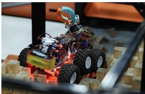
Конструкция из деревянных брусков 50x50мм разной длины, установленных вертикально, плотно друг к другу. Испытание размещается в одном стандартном кубе высотой 800 мм.
