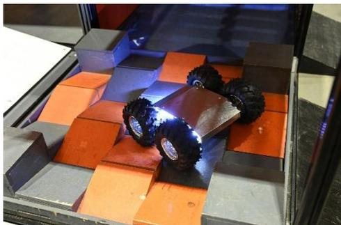
Ячейка заполнена 25-ю закрытыми коробами (рампами). Верхняя грань каждого короба имеет наклон в  $15^\circ$ . Рампы составлены таким образом, что их верхние поверхности образуют по высоте волнообразную структуру.
