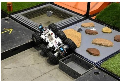
Плоская площадка, на которой закреплены камни с острыми углами и резкими перепадами по высоте от 1 до 60 мм.
