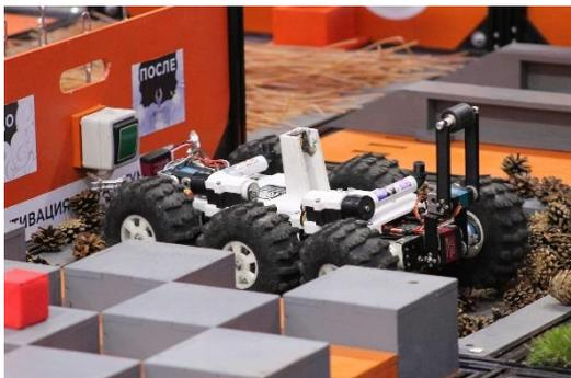
Испытание на проходимость, для его создания используются реальные шишки, которые засыпаются в короб на глубину 40 мм.
