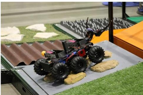
Плоская площадка, установленная под углом 15 градусов, на которой закреплены камни. Высота камней - 15-40 мм.
