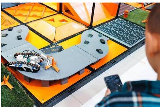
Испытание состоит из трех ячеек – заезд, плоская часть и съезд. На площадках въезда и выезда закреплены дополнительные помехи в виде выступов и нанесены контрольные линии. Робот должен проехать по эстакаде, моделирующей реальный наземный виадук.
