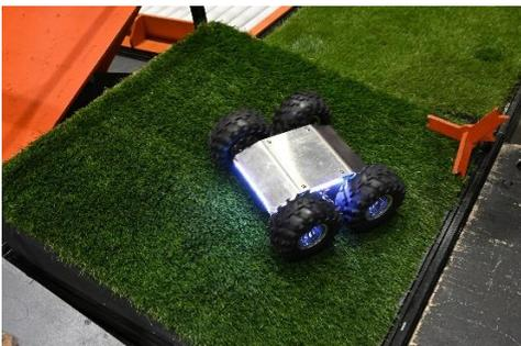
Плоская площадка, установленная под углом 15 градусов, на которой закреплена полоса искусственной травы. Высота ворса — 40 мм. Ширина искусственной травы может варьироваться.
