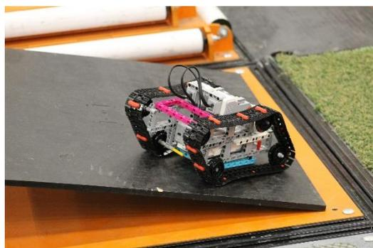
На плоском основании установлена квадратная платформа, закрепленная при помощи крестовины, обеспечивающей ее наклон в разные стороны. Максимальный угол наклона весов - 30°. Высота в центре - 90 мм, сторона квадратной платформы - 640 мм.
