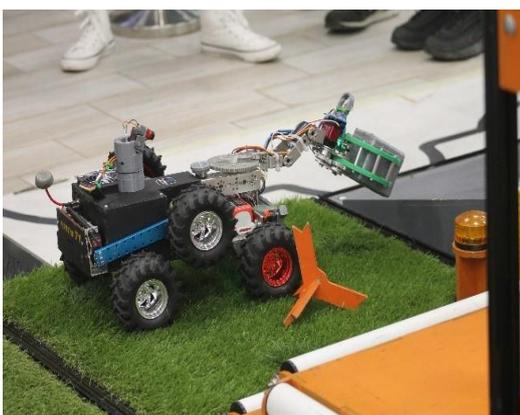
Мины представляют собой цилиндры, утопленные в поверхность ячейки с травой. Нажатие на шайбу имитирует активацию мины и сопровождается звуковым и/или световым сигналом. За одну попытку каждую мину можно активировать только один раз. Робот может намеренно обезвредить мину, нажав на нее каким-либо посторонним предметом. За активацию мины какой-либо частью робота команда получает штраф.
