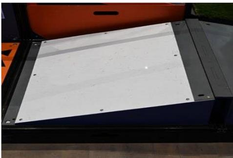
Плоская площадка, установленная под углом 15 градусов, на которой закреплена пластина из полистирола, имитирующая лед.
