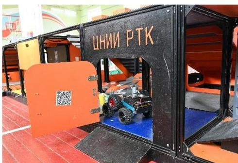
Дверь, открывающаяся на 90° на себя и от себя с ручкой типа «штанга». Габаритные размеры двери - 480x480 мм.
