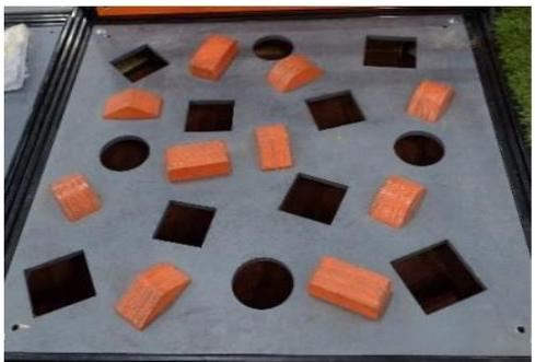
Плоская площадка с отверстиями различной формы. Также, на площадке в произвольном порядке расположены препятствия – шипы из фанеры различной формы. Высота шипа - 50мм. Ширина отверстий до 120 мм.
