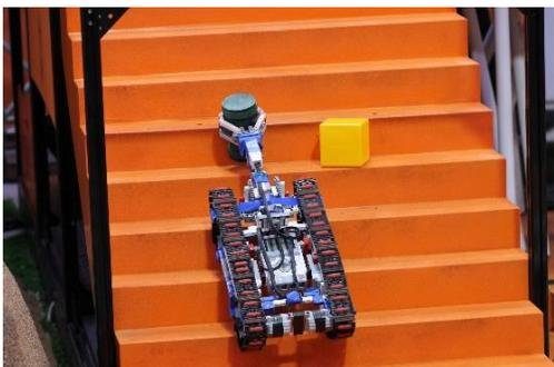
Куб, внутри которого расположена лестница с высотой ступеней 75 мм и длиной 90 мм. Лестница включает в себя прикручиваемый заезд, вместе с которым состоит из одиннадцати равных прямоугольных ступеней.
