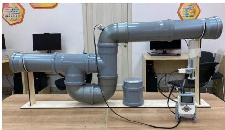
Фото 6 - Модель фрагмента межпоселкового газопровода
