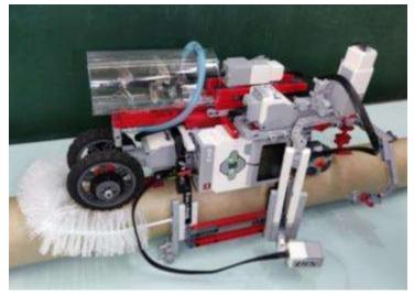
Макет ТрубоБота мы собрали из конструктора Lego Mindstorms EV3. Для этого нам понадобились: 2 микроконтроллера для написания программы в графической среде EV3, 2 больших сервомотора, 3 малых мотора, 3 датчика цвета и детали Lego, также мы использовали щетки, подручный материал для изготовления гидроэлектростанции и картонную трубу.
