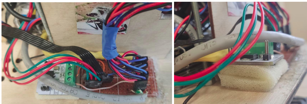
переходная плата с портов MakeBlock RJ12 на разъемы с шагом 2.45 мм, стабилизатор питания с 5 В до 3.3 В
