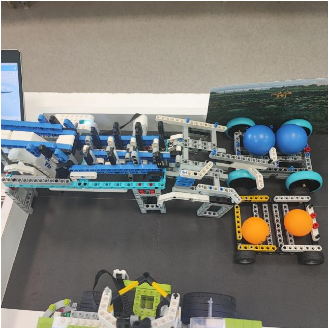
Рис.4 Сортировочный комплекс, «арбузы» отсортированы по размеру.
