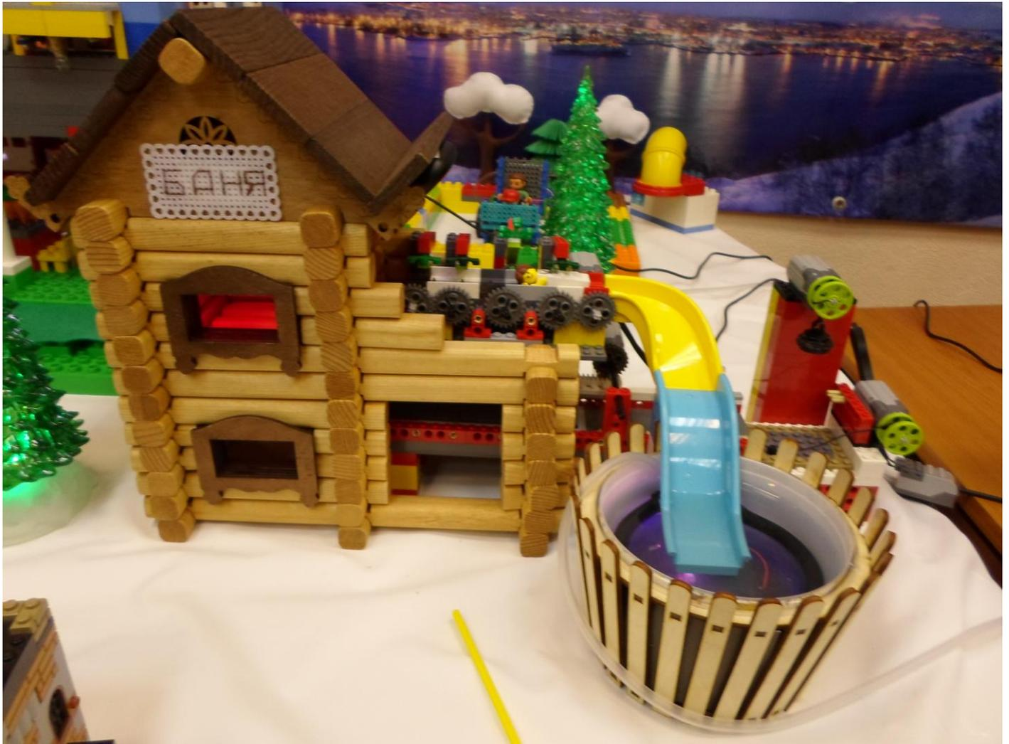
вениками и движущей платформой. Движущую платформу приводит в действие мотор, для этого используется прямая и холостая передачи, а также работы веников используются кулачковые механизмы.
