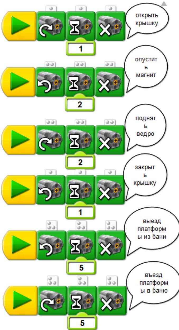
Парная машина в бане работает следующим образом: приводит в движение платформу мотор (со средней скоростью – 5) – сначала вперед 3 секунды, затем назад 2 (чтобы не
