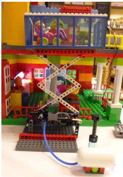
После первичной доработки появилась еще одна проблема: корпус лифта получился очень тяжелым и механизм просто его не смог его поднять. Данная конструкция после экспериментов была отправлена на вторичную доработку – пришлось максимально облегчить корпус лифта, чтобы лифт смог заработать.
