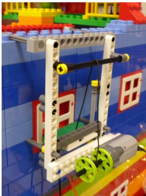
закрепленной струны, приводя во вращение крупный валик, который и осуществляет мытье окна. За основу была взята идея работы сортировщика из ресурсного набора 9585, который совершает поступательные движения вверх-вниз как раз за счет мотора и струны. После первичной сборки выявились следующие проблемы: из-за того что мотор в подвешенном состоянии, вся конструкция перевешивает в сторону мотора. Ситуация была разрешена путем установки упоров в нижней части
