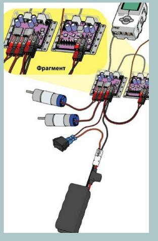
Функциональная схема верхней части робота
