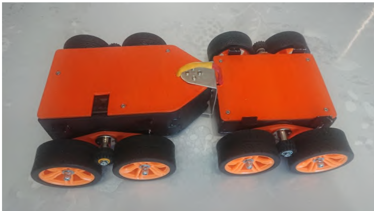
Фото 13. Установка крышек корпусов. Готовность шасси
