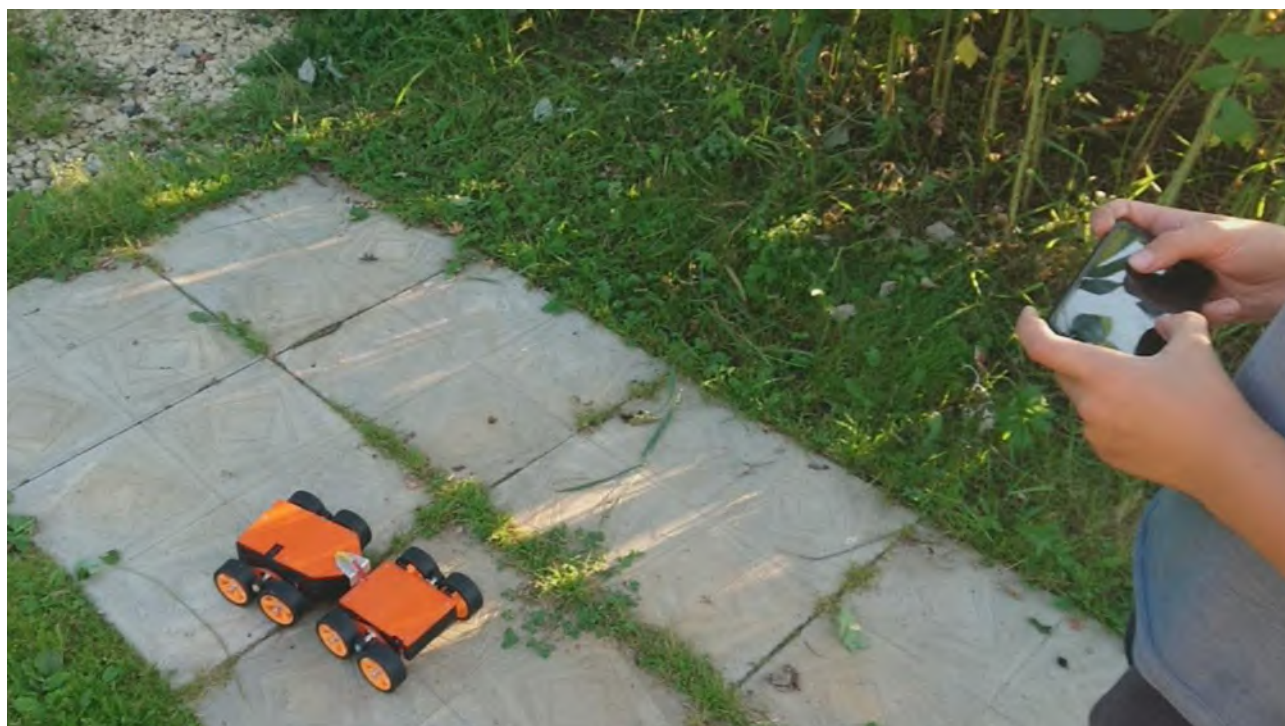
Фото 20. Эксплуатационные ходовые испытания шасси на ровном покрытии
