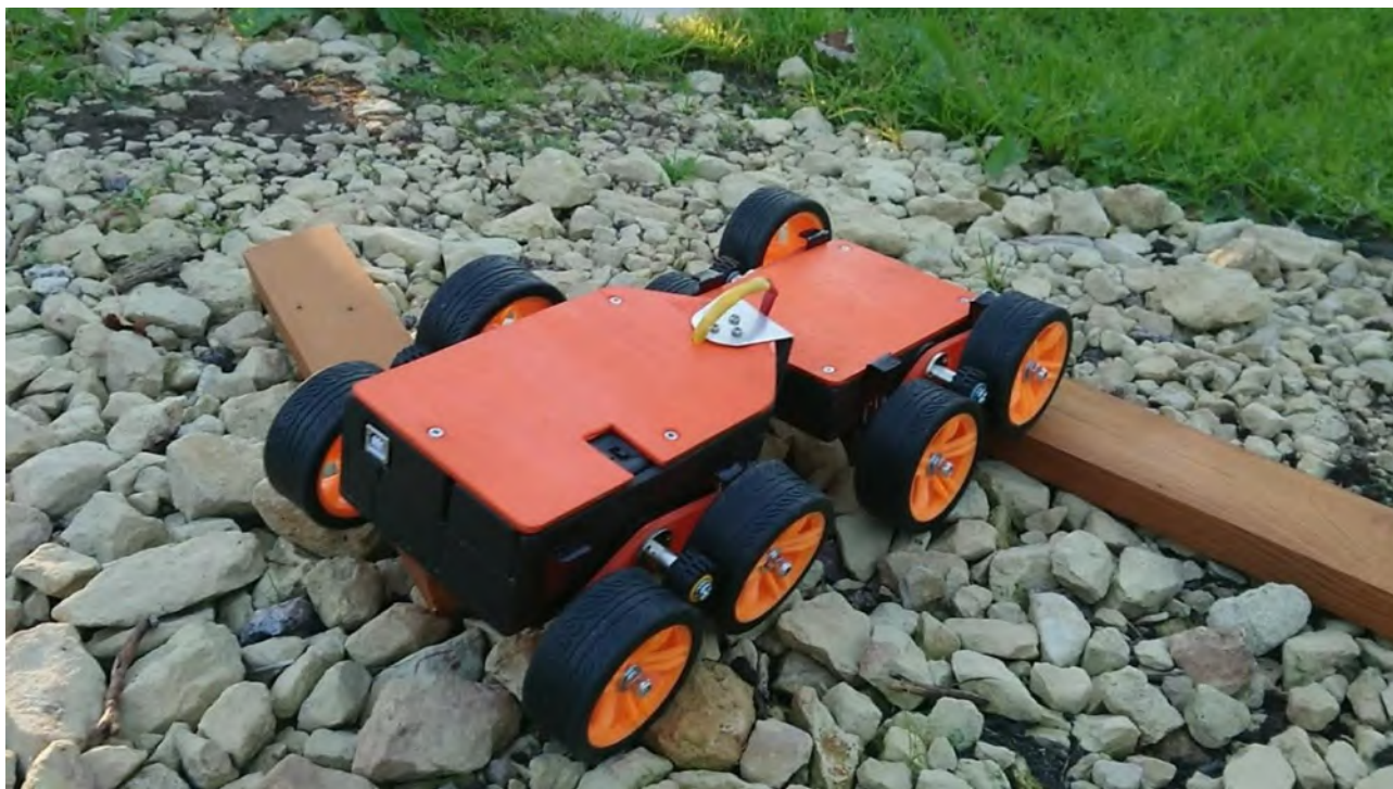
Фото 21. Эксплуатационные ходовые испытания шасси во внедорожных условиях
