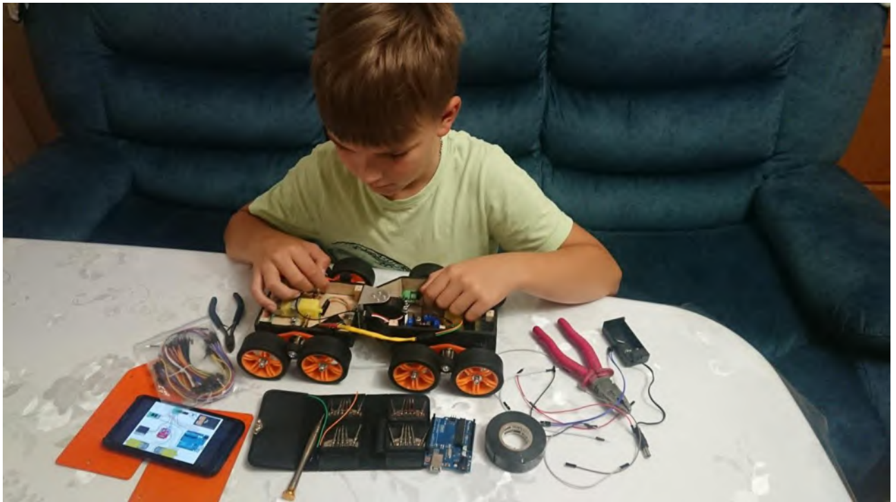
Фото 11. Сборка электротехнической схемы и отладка работы моторов шасси
