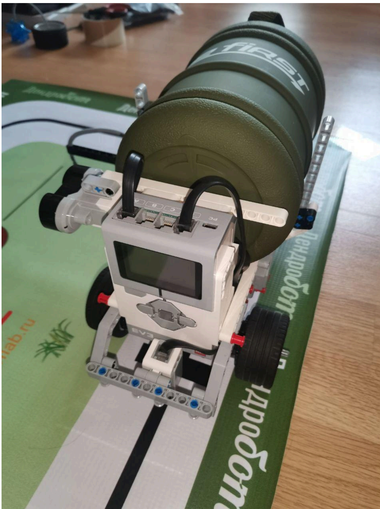
Рисунок 5: Создание робота для полива саженцев
