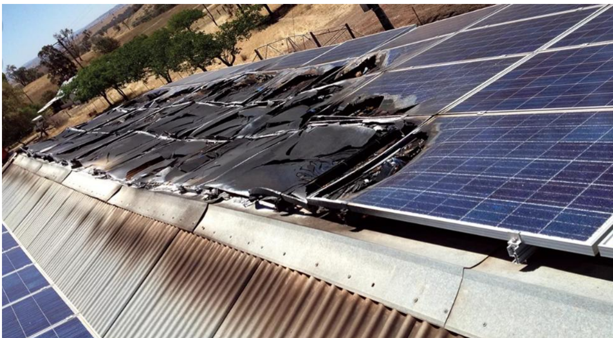
Рисунок 9. Самовозгорание панелей от перегрева. Китай.
