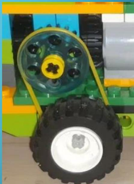
У робота сдвоенная угловая передача, для того, чтобы одним мотором крутить бур и ехать вперед или назад. И две ременные передачи на колеса.
