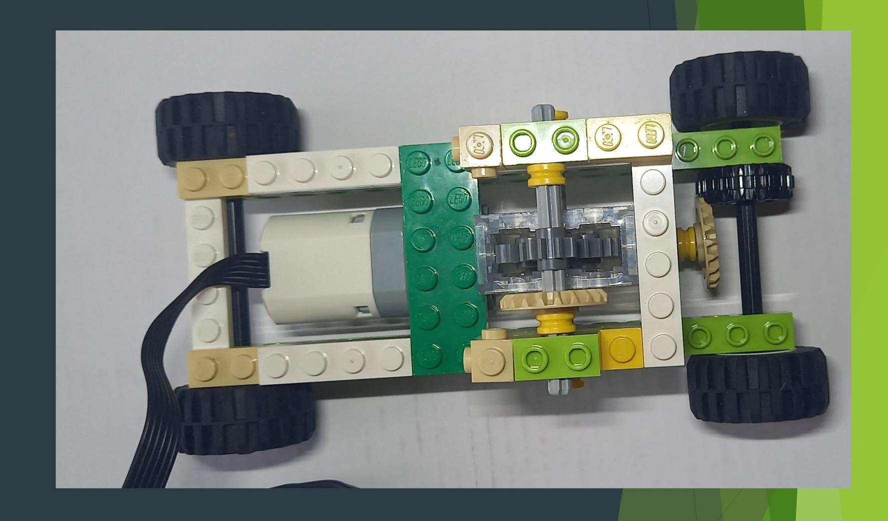
Передача вращения от мотора к башне осуществлена при помощи червячного редуктора и конической шестерни.
