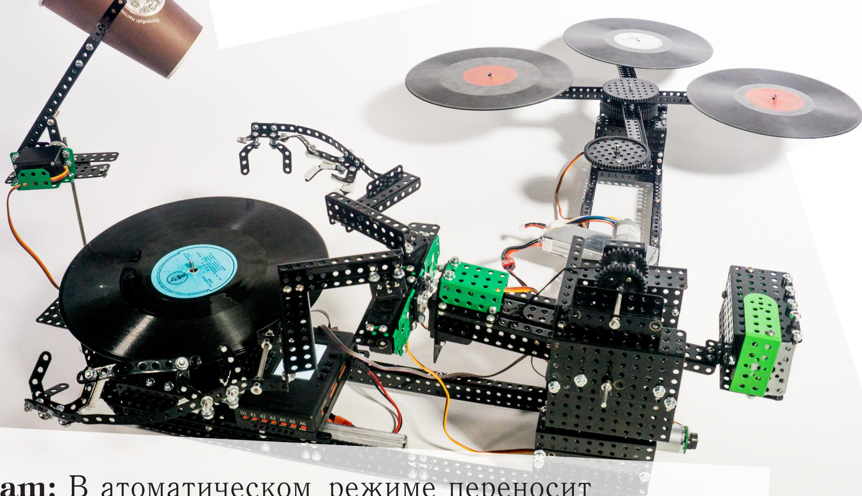
**Хват:** В автоматическом режиме переносит пластинки от хранилища к проигрывателю, а так же переворачивает их.
