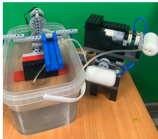
Вся конструкция целиком: насосы, резервуар с горячей водой и насос перегоняющий воду, в резервуар для таяния снега
