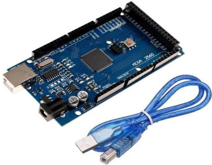
**Контроллер Arduino Mega 2560 R3** это главное управляющее устройство, отвечает за управление двигателями и создает обратную связь с приложением.
