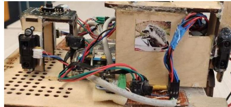
2) meAURIGA и Raspbberу, USBhub, самодельный UARThub, переходная плата с портов MakeBlock RJ12 на разъемы с шагом 2.45 мм, стабилизатор питания с 5 В до 3.3 В и инфракрасные
